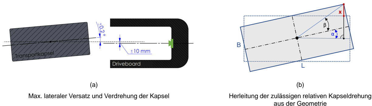
Abb. 6.1: Toleranzbetrachtung bei der hochpräzisen Positionierung des U-Shift Fahrzeugs während des Modulwechsels. [eigene Darstellung, nicht maßstabsgetreu]
