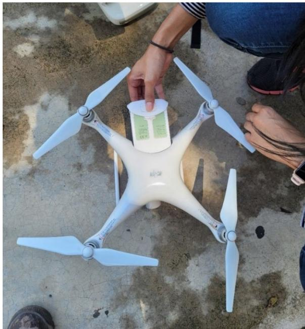
*Imagen 3- 43 Colocación de batería al dron.*
