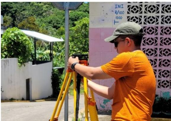
*Imagen 3- 11 Colocación de base nivelante sobre trípode.*
