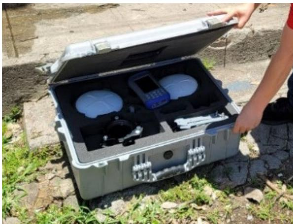
*Imagen 3- 7 Extracción de los receptores GPS.*
