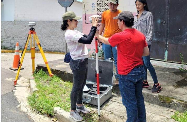
*Imagen 3- 18 Enroscando el receptor móvil al bastón.*
