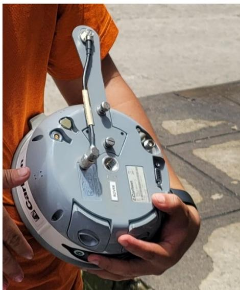
*Imagen 3- 17 Receptor móvil con soporte y antena enroscada.*
