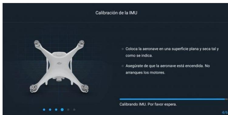
Imagen 3- 51 Cuarto paso de calibración de la IMU
