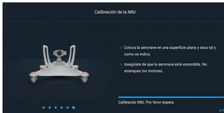
*Imagen 3- 53 Sexto paso de calibración de la IMU*
