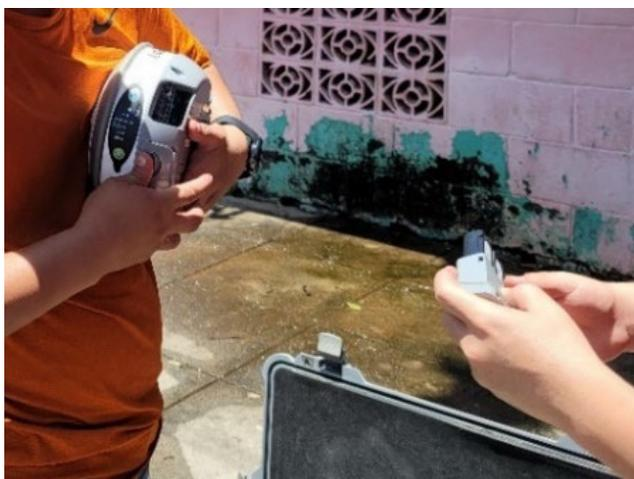
*Imagen 3- 8 Colocación de baterías en el receptor.*
