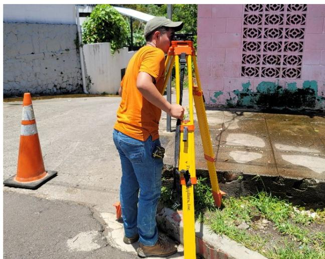
*Imagen 3- 12 Corrección de trípode y base nivelante.*
