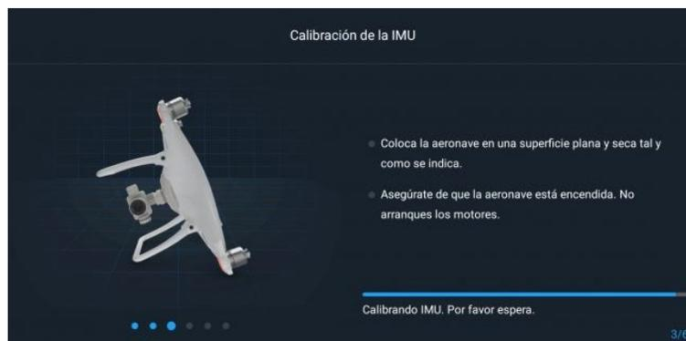
Imagen 3- 50 Tercer paso de calibración de la IMU
