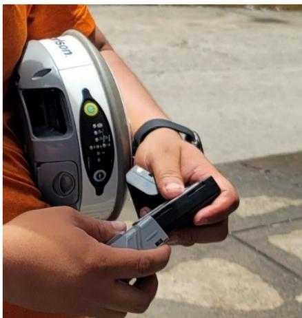
*Imagen 3- 16 Insertando baterías en el depósito del receptor móvil.*
