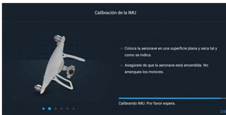
*Imagen 3- 49 Segundo paso de calibración de la IMU*
