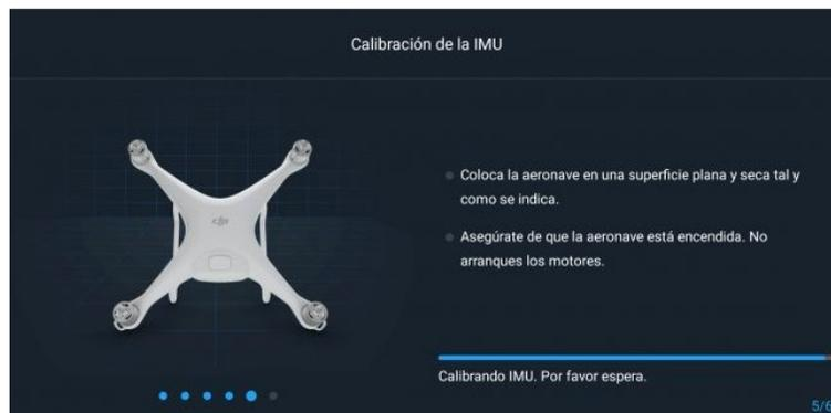
Imagen 3- 52 Quinto paso de la calibración de la IMU
