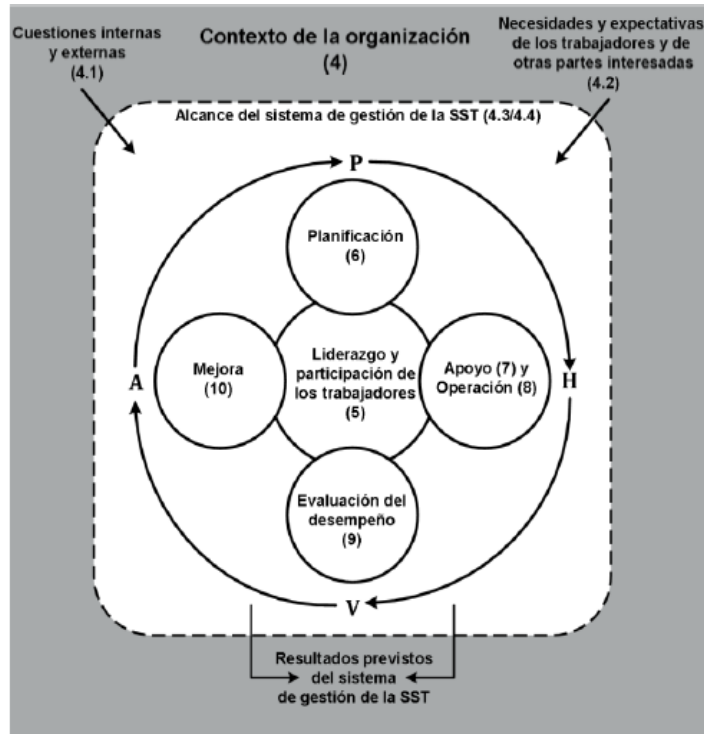
Ilustración 20: Estructura de la Norma ISO 45001
