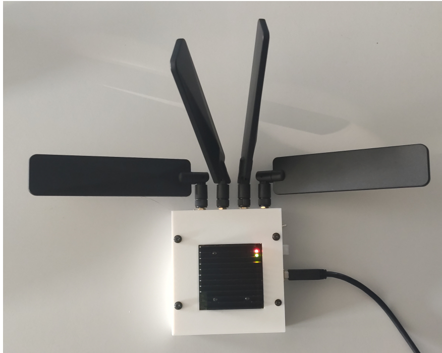
Obrázek 2.2: Vývojový kit s čipovou sadou RM530N-GL
