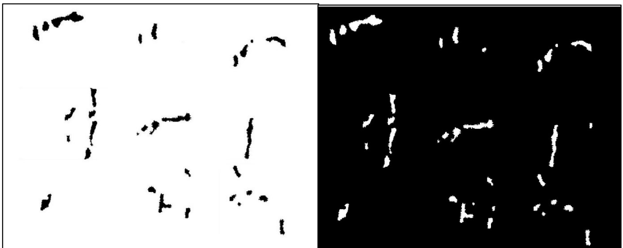
Obrázek 29 Aktivní kontury s 10 iteracemi+binární inverze, levá strana obsahuje aktivní kontury, pravá strana obsahuje binární inverzi: Zdroj vlastní
