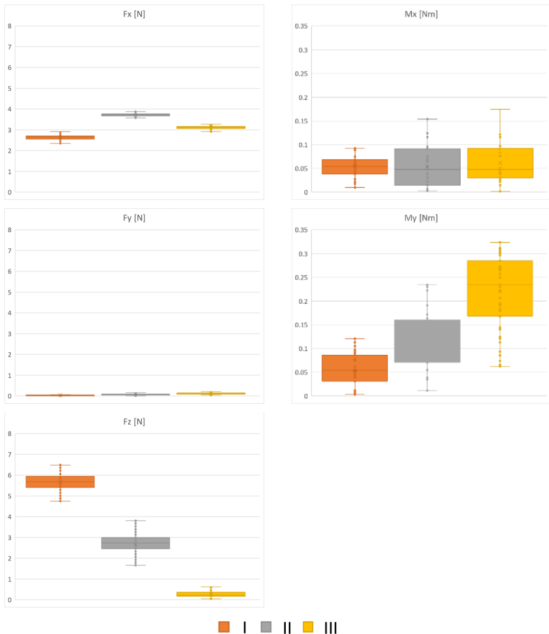
Obrázek 49 – Zobrazení rozptylu hodnot měření v pozicích I, II a III pomocí boxplotů (a) síly v osách X, Y, Z (b) momenty kolem os X, Y, Z
