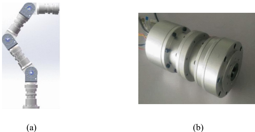
Obrázek 2 – (a) DoF manipulátor (b) kloub manipulátoru [2]
