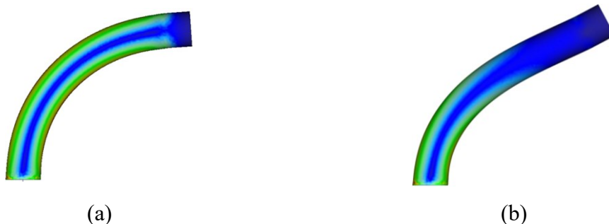
Obrázek 58 – Porovnání rozložení ekvivalentního napětí při deformaci segmentu do III (a) 2D ohyb do pravidelného oblouku, (b) 2D ohyb po evolventě
