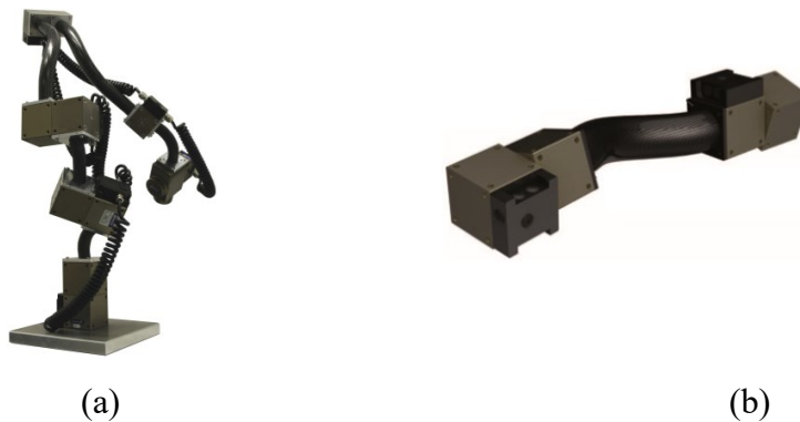
Obrázek 1 – (a) manipulátor CUMA v jedné z konfigurací (b) zakřivený segment s pohybovými jednotkami [1]
