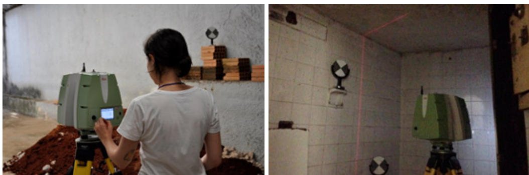
Figura 12: Utilização do Laser Scan para mapear o DOPS/MG.
