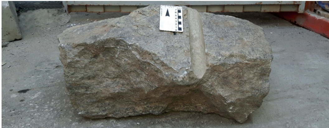
Figura 14: Bloco de rocha com marca de perfuração associável a extração com uso de explosivos. Fonte: Fotografia de Anderson Marques Garcia.
