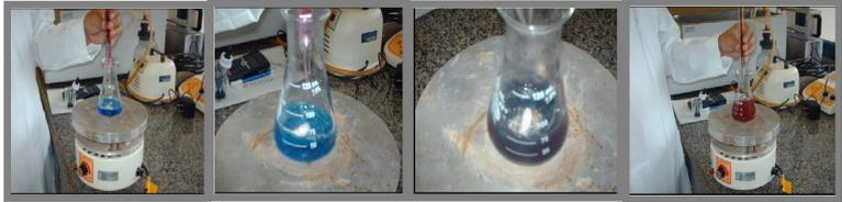
Figura 1: Procedimentos de titulação para obtenção do teor de amido
