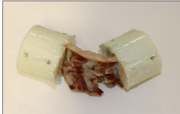
Abbildung 20: Gewebszerreißen zwischen dem zweiten und dritten Lendenwirbel bei Wirbelsäulensegment 11 während des Versagenstests unter lateraler Biegung nach der Anlegung eines Drehmoments von 13 Nm
