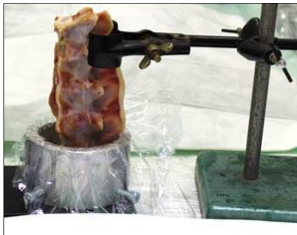
Abbildung 5: Ausrichtung eines Wirbelsäulensegments innerhalb der Einbettwanne zur nachfolgenden Einbettung des kaudalen Wirbelsäulensegmentanteils in Gießharz - Seitliche Ansicht
