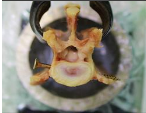
Abbildung 4: Ausrichtung eines Wirbelsäulensegments innerhalb der Einbettwanne zur nachfolgenden Einbettung des kaudalen Wirbelsäulensegmentanteils in Gießharz - Aufsicht
