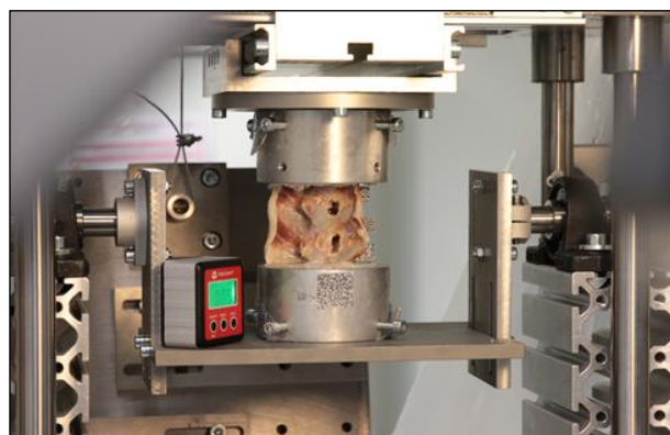
Abbildung 9: Ausrichtung eines eingebetteten Wirbelsäulensegments innerhalb des Wirbelsäulenprüfstandes entsprechend der Ausgangsposition
