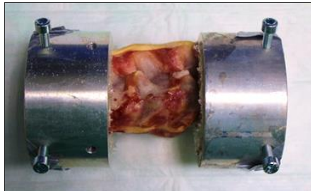
Abbildung 7: Vollständig eingebettetes Wirbelsäulensegment – Seitliche Ansicht
