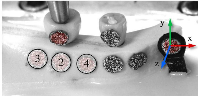
**Abb. 38:** Bezugspunkt Zielmarker 2, distaler Zielmarker 3 und mesialer Zielmarker 4 zur Auswertung der Ausweichbewegungen im erweiterten knöchernen Umfeld des Dentalimplantats
