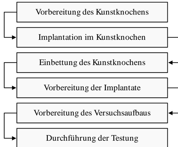
**Abb. 25:** Ablaufplan für die Hauptversuche zur Testung der Implantatsysteme im Kunstknochen
