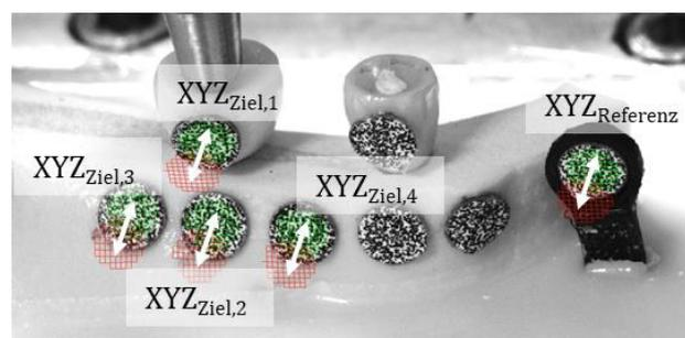
**Abb. 35:** Bestimmung der Absolutbewegungen der Zielmarker ( $XYZ_{Ziel,1-4}$ ) und Referenzmarker ( $XYZ_{Referenz}$ )
