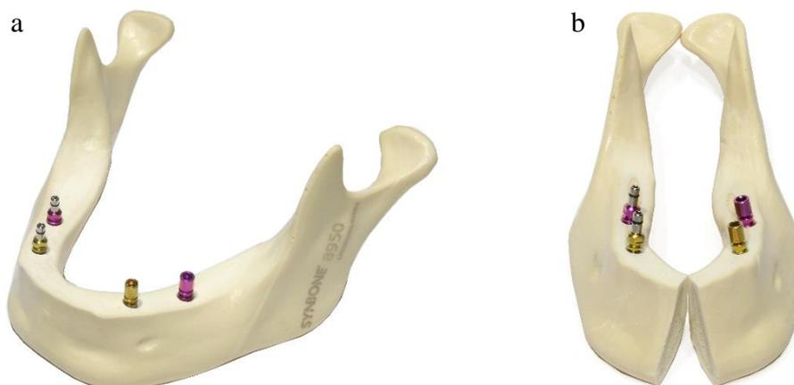
**Abb. 27:** a – Zahnloses Kunstknochenmodell der Mandibula nach der Implantation der CAMLOG®-Implantate (Positionen 44 und 46) und CONELOG®-Implantate (Positionen 34 und 36), b – In der Sagittalebene geteiltes Kunstknochenmodell der Mandibula
