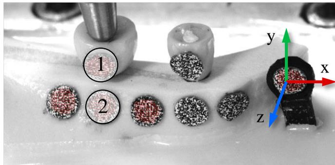
**Abb. 36:** Zielmarker 1 und Zielmarker 2 zur Auswertung der Mikrobewegungen der Zahnkrone
