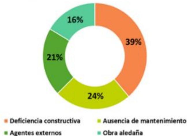
Resumen de las posibles causas identificadas de las afectaciones de edificaciones
