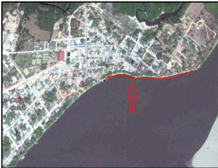
*Figura 4.* Casco Urbano municipio de Orocué Casanare. En rojo se resalta el sector de mayor impacto de socavación, en el cual se proyecta realizar las obras de protección.
