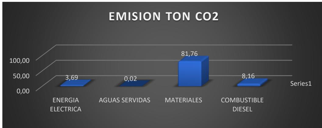
Figura 16. Emisión CO2 por material. Descripción de la cantidad de emisión en TON de CO2 para los principales materiales usados en el proyecto.
