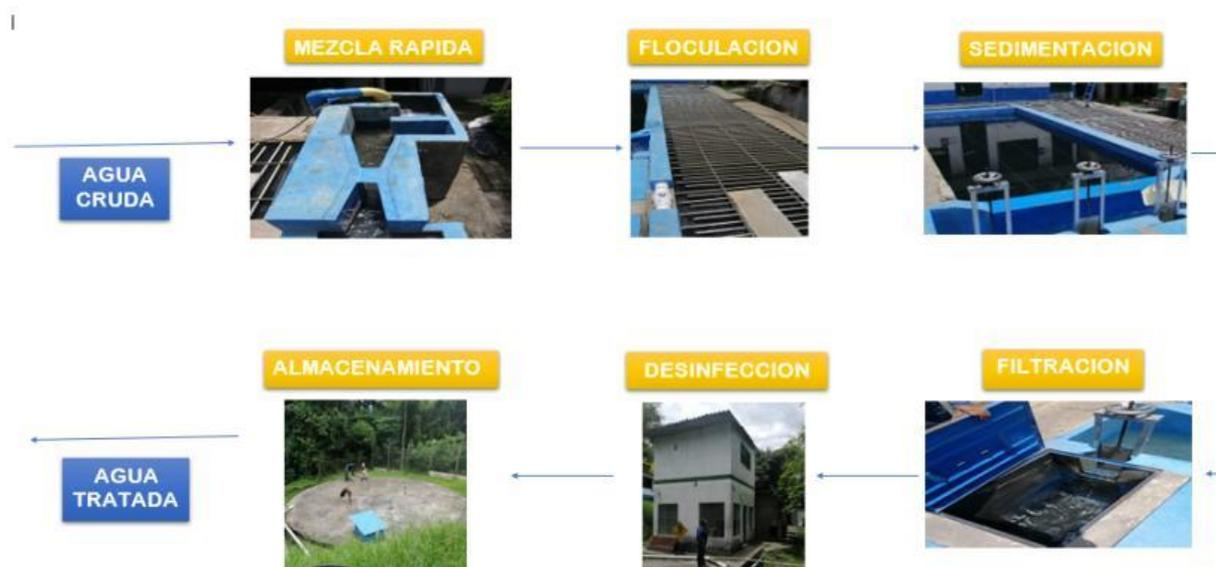
Ilustración 4 Esquema del proceso de potabilización de agua en la PTAP "La Laja" Fuente propia
