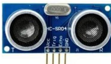
*Ilustración 7 Sensor Ultrasónico HC-SR04 <https://www.xataka.com/basics/que-arduino-como-funciona-que-puedes-hacer-uno>*
