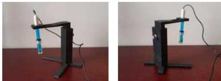
Ilustración 6. Soporte del sensor impreso en 3D.
