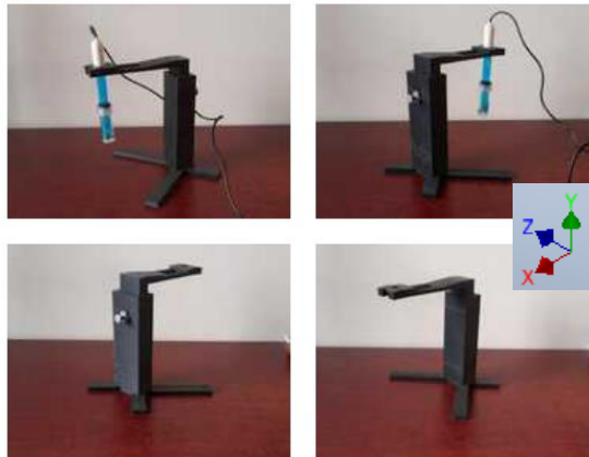
Ilustración 42. Soporte del sensor impreso en 3D.
