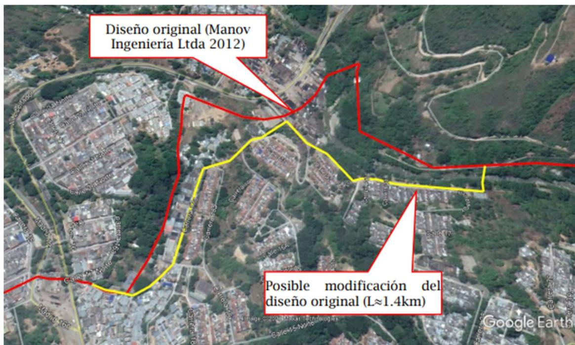
Figura 5. Trazado original de la línea de conducción Planta Angelinos – Tanque Girón Mayor y trazado de la posible modificación entre K0+915 y K2+340 del diseño original.
