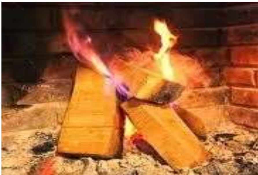
Figura 6. Madera expuesta a temperatura de 270 a 350 °C.
