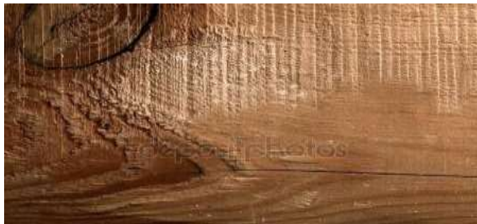
Figura 4. Madera expuesta a temperatura menor a 100 °C.
