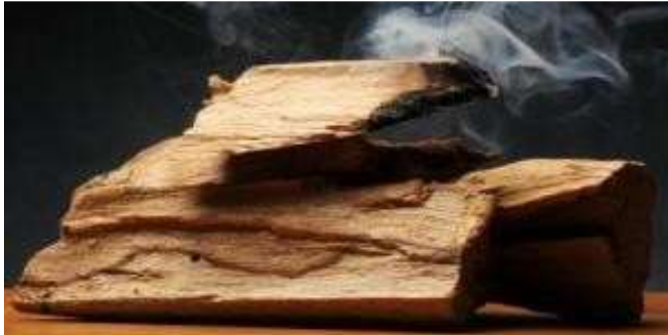
Figura 5. Madera expuesta a temperatura de 100 a 270 °C.
