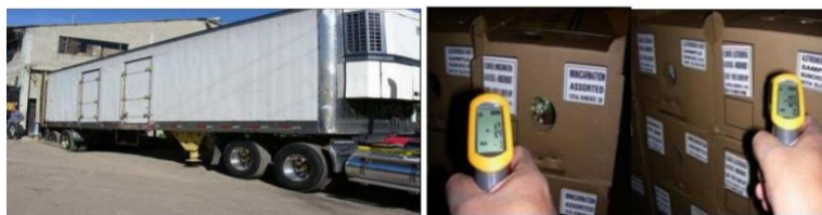
Figura 25: Toma de temperatura para el vehículo y el producto de la Rosa.
