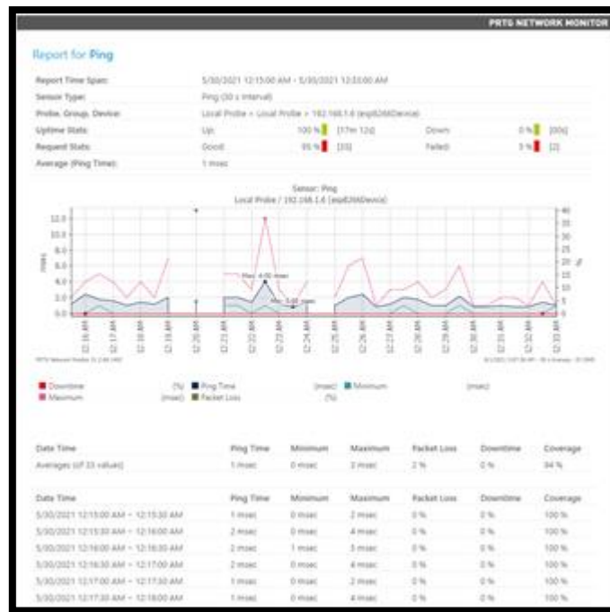
Figura 45 pruebas de conexión del módulo ESP8266, (fuente: Autor)
