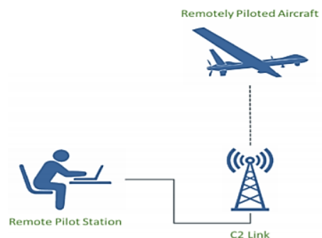
Fig. 2. Radio Line Of Sight – RLOS Fuente: Organización de Aviación Civil Internacional https://www.icao.int/
