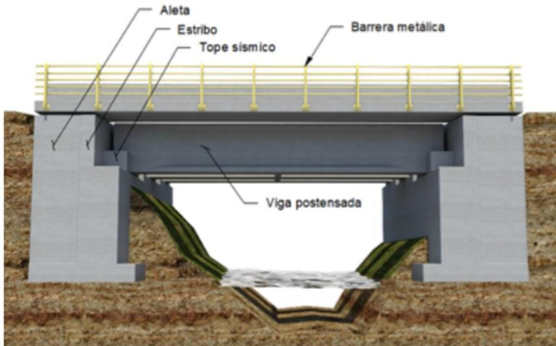
Figura 8. Elemento del puente
