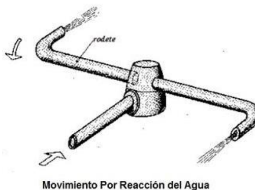
Figura 13. Turbina por Movimiento de Reacción del Agua.
