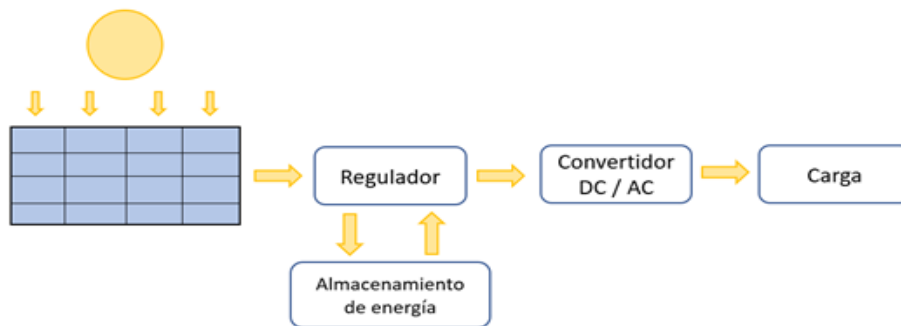
Ilustración 8 Estructura general sistema fotovoltaico
