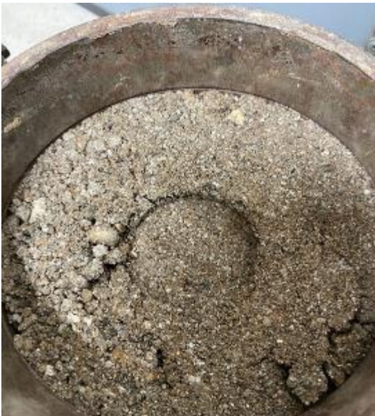
Ilustración 33 Falla de Muestra inalterada Del apique N°1 Fuente: Elaboración Propia
