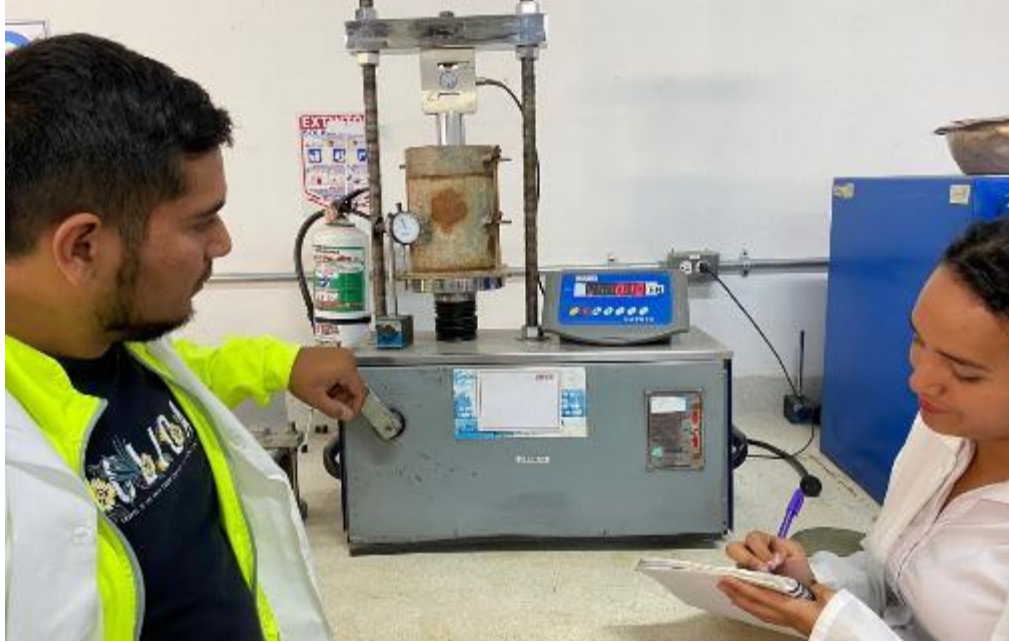
Ilustración 32 Recolección de datos durante el ensayo de CBR% fuente: Elaboración propia
