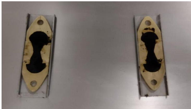
Figura 12 Moldes con asfalto ya enrazados, Fuente propia
