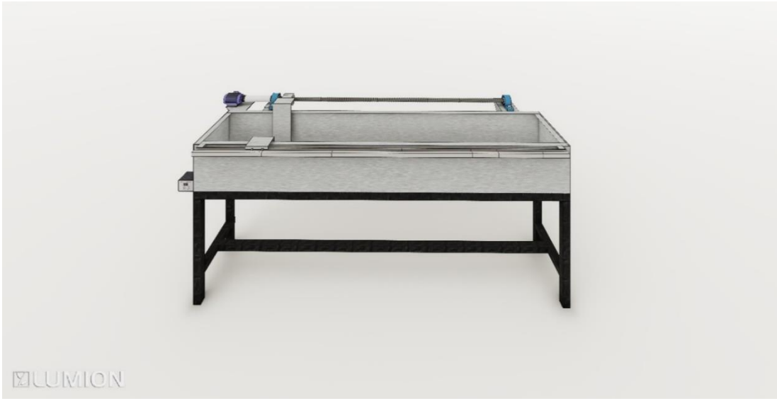
Figura 7 Diseño ductilómetro, Fuente propia software utilizado (SketchUp Pro-2022) y (Lumion 12.3 Trial)
