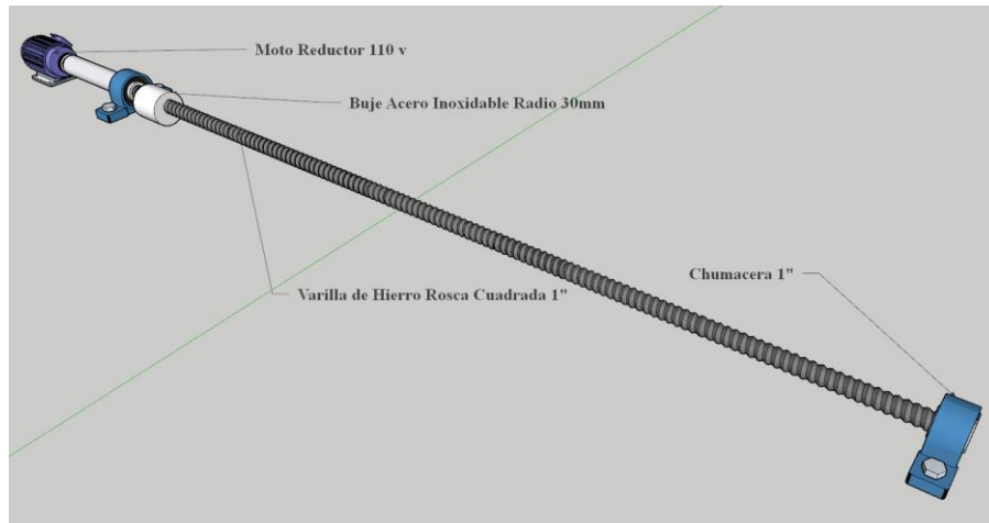
Figura 3 Diseño de varilla de 1 pulgada y motorreductor, Fuente propia software utilizado (SketchUp Pro-2022)
