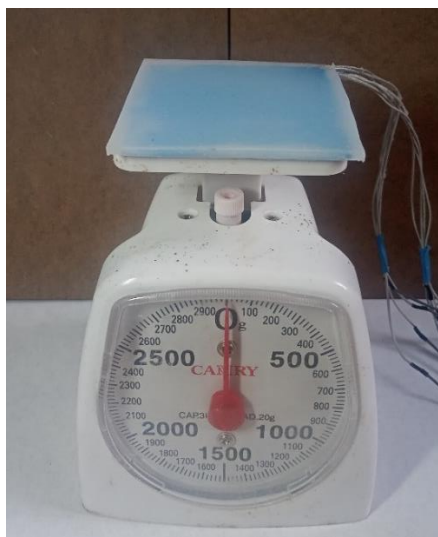
Ilustración 48: Ensayo de fuerza del sensor táctil con Velostat.
