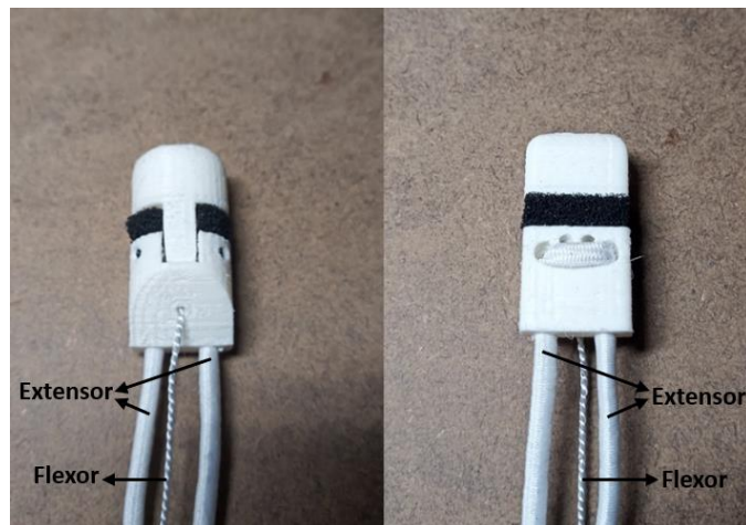
Ilustración 7: Instalación de tendones y espuma del sensor.
