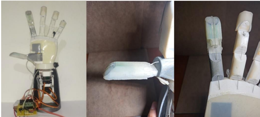
Ilustración 63: Mano robótica con sensor táctil de fuerza resistivos FSR.
