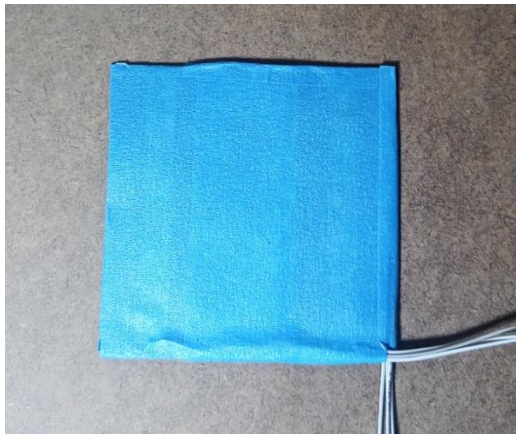
Ilustración 42: Fijación de las capas y cableado de la matriz sensorial.
