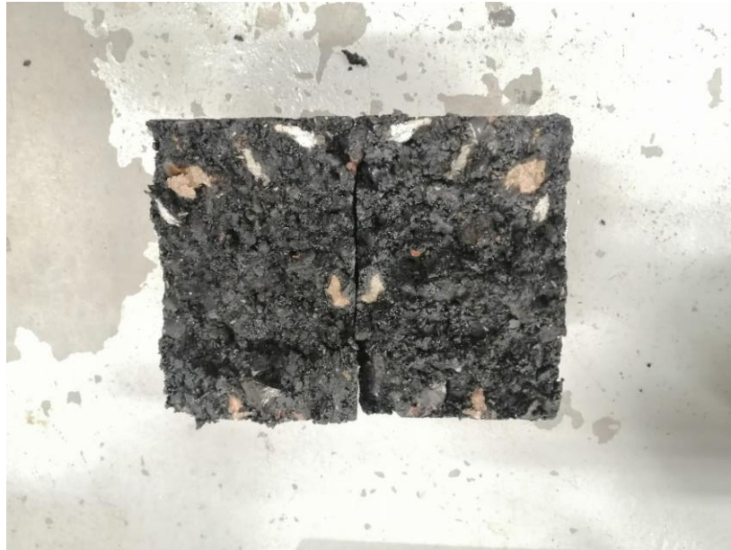
Figura 6. Probeta N°7 fallada por carga máxima
