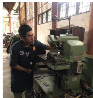
Gambar 2 Proses pembentukan kampuh v 60°
