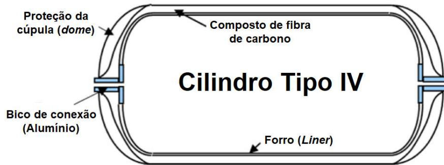
Figura 2.7 - Principais elementos de um vaso de pressão de hidrogênio comprimido Tipo IV (Adaptado de JOHNSON et al. , 2017).
