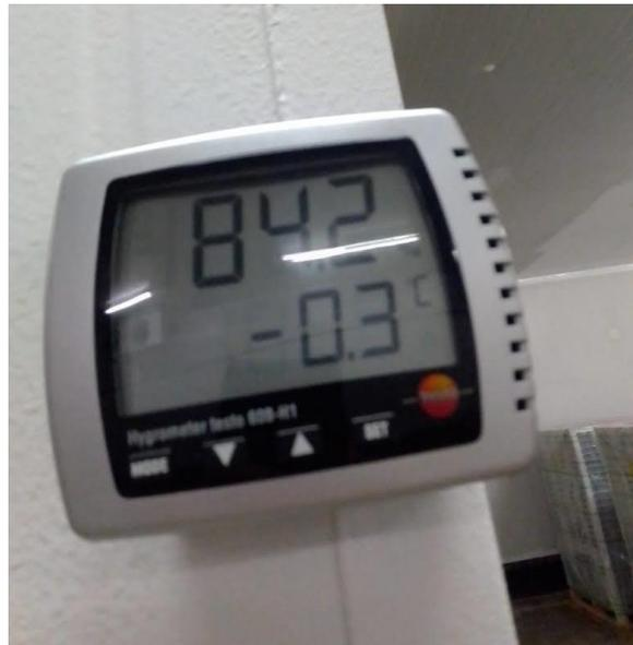
**Figura 35: Temperatura y humedad relativa dentro de la cámara de almacenamiento de producto terminado**
