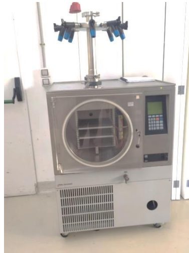
Figura 40. Equipo de liofilización (Heto-Holten Modelo FD8) de la Planta Piloto de Ciencia y Tecnología de los Alimentos (CTA) de la Facultad de Veterinaria de Zaragoza.
