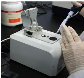
Figura 29. Colocación de muestra en el espectrofotómetro Nanodrop TM 2000 UV-Vis .
