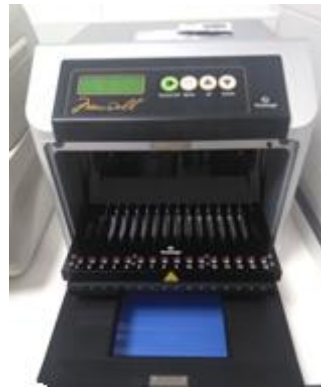
Figura 28. Aparato automatizado Maxwell® para la extracción del DNA.
