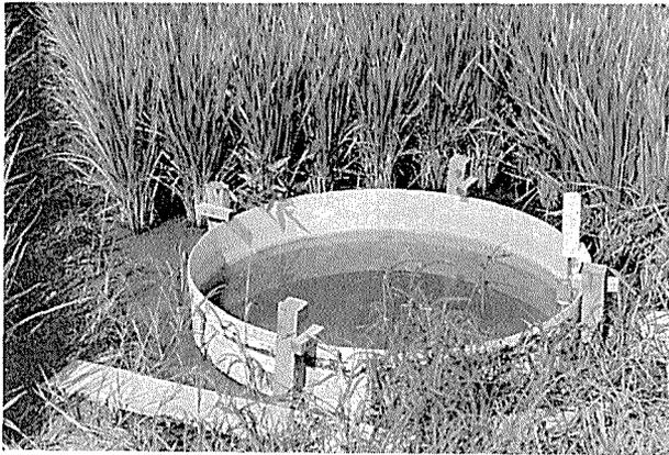
図-12 蒸発位  $E_V$  測定用大型蒸発計
