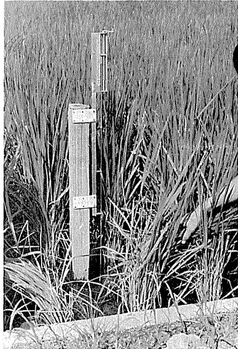
図-15 水田貯留量変化量測定用フックゲージ
