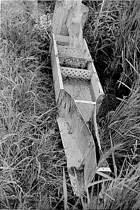
図-14 各筆ごとの水田への流入量  $Q_{in}$  測定用パーシャル・フリュウム
