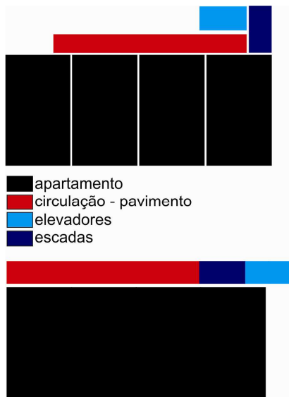
Figura 11: Diagramas ilustrando a proporção de área de circulação por área de habitação. Alternativa 01. (Fonte: Autor, 2011)
