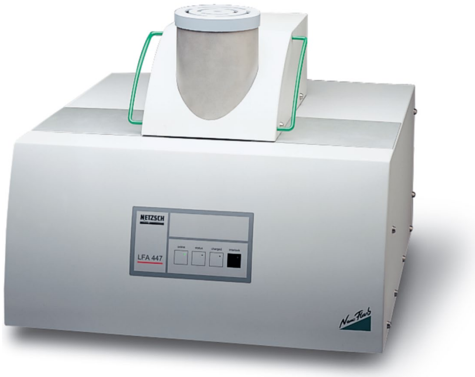
Figure 9: Laser Flash Analysis Apparatus LFA 447 (Netzsch Gerätebau GmbH) [6].
