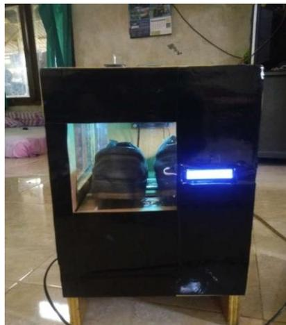
Gambar 12. Proses Sterilisasi Sepatu Safety
