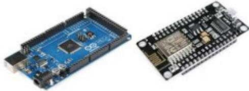
Gambar 1. Arduino Mega 2560 dan ESP 8266
