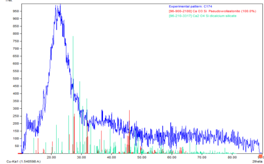
Gambar 6. Pengujian XRD pada serbuk CaSiO 3
