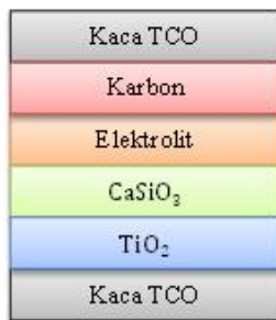
Gambar 2. Susunan perovskite solar cell
