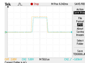
Gambar 13. Gelombang tegangan keluaran dan masukan opto-isolator
