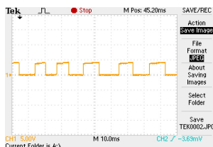
Gambar 11. Tegangan keluaran pada rotary encoder
