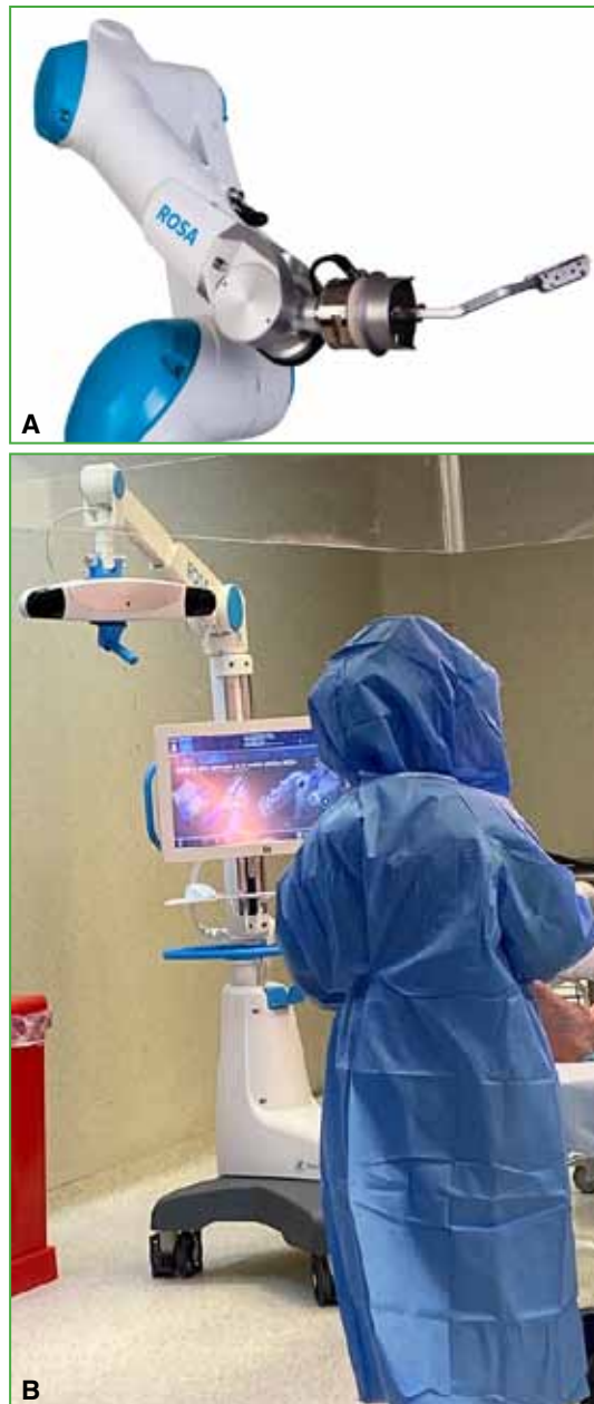
Figura 3. Brazo robótico con la guía de corte (A) y la óptica (B).
