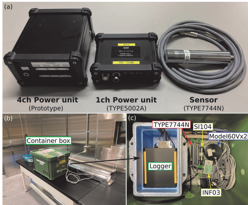
図 2 試験に用いた機材. (a) アコー製新型空振計の外観. 左から 4 チャンネル電源装置 (試作機), 1 チャンネル電源装置 (TYPE5002A), センサ (TYPE7744N). (b) 低温試験を実施した極地研低温環境実験室. (c) 低温試験に用いた機材.
