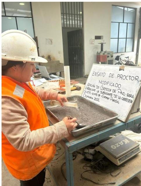
*Figura 13.* Colocación de líquido a la muestra de suelo para el ensayo de Proctor modificado
