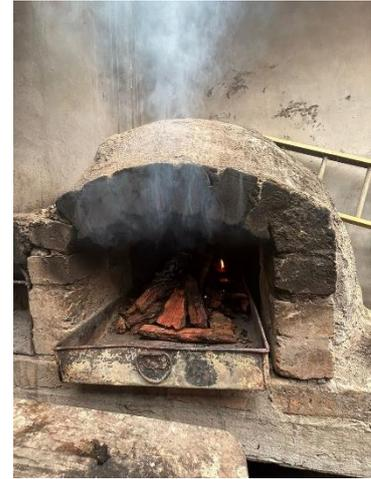
*Figura 3.* Calcinación de Corteza de Pino a 550°C a 600 °C
