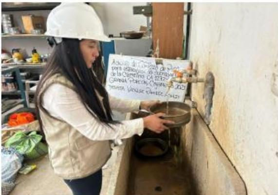
FOTO N° 07: Lavado de muestra para el analisis granulometrico
