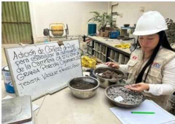
FOTO N° 08: Verificación del Material en seco
