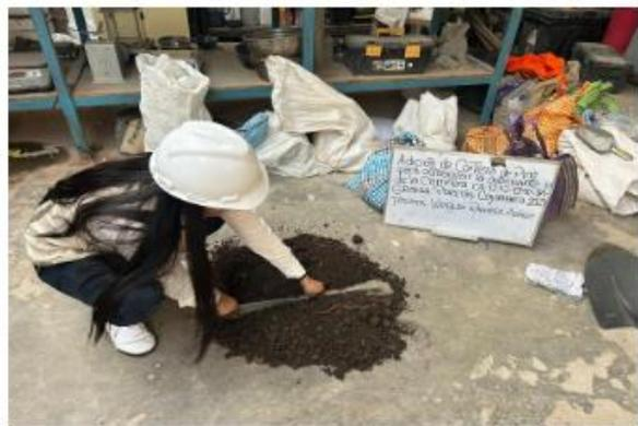
FOTO N° 06: Cuarteo de muestra para el analisis granulometrico
