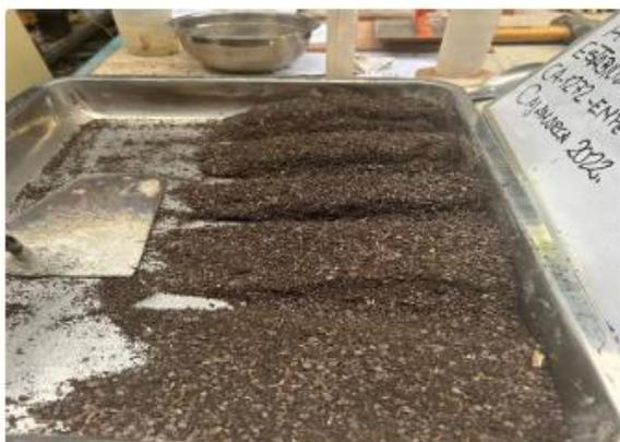
FOTO N° 10: Cuarteo para colocación en el recipiente de compactación
