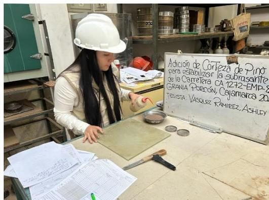
Figura 17. Ensayo de Limite Plástico para el Índice de Plasticidad
