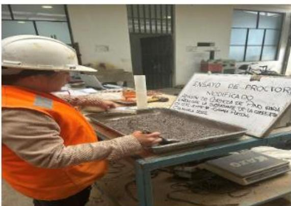
FOTO N° 09: Mezcla y dosificación de agua para el ensayo Proctor modificado
