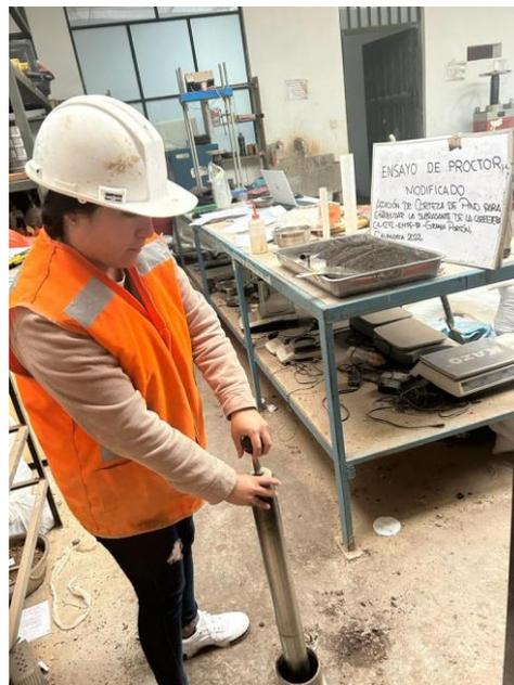
*Figura 12.* Compactación de suelo por medio del martillo manual para el ensayo de Proctor Modificado
