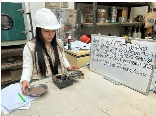
Figura 16. Ensayo de Limite Liquido para el Índice de Plasticidad
