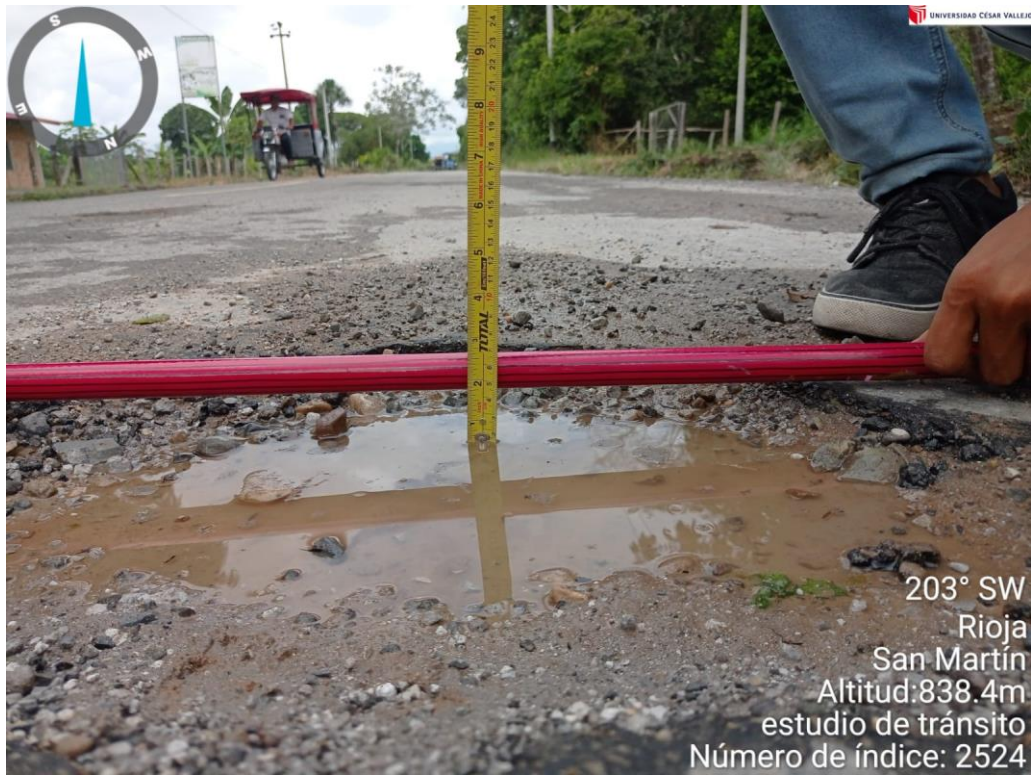
Figura 51: Vista del estado actual de tramo de carretera entre los pueblos vecinos POSIC – RIOJA KM 2+746– medición de unidades de muestra, profundidad baches.
