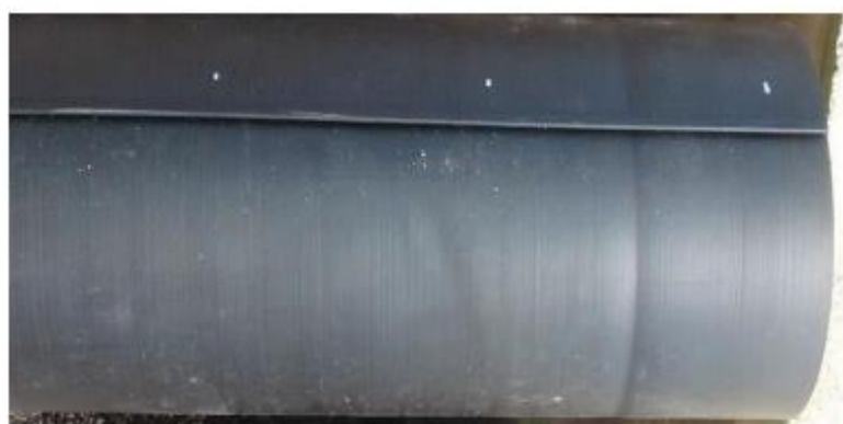
Figura 10: Aplicación de HDPE Jacket
