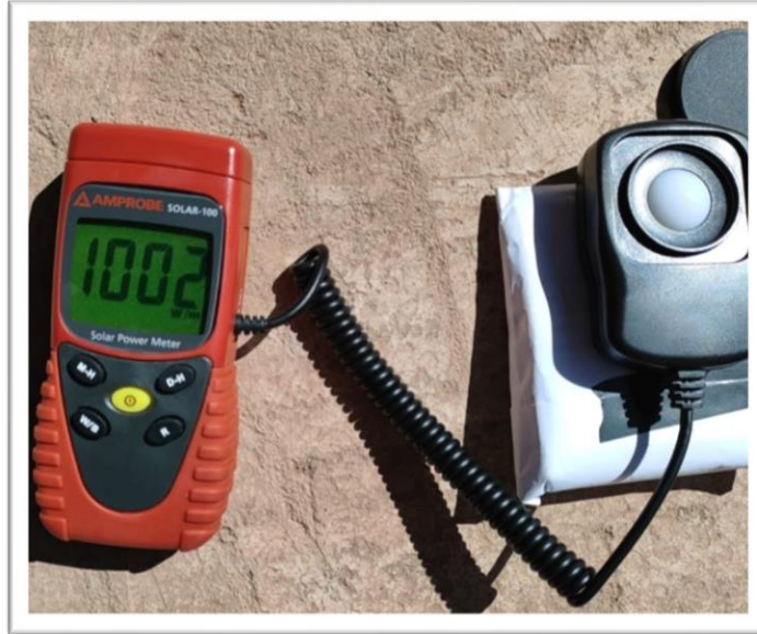
Figura 16. Medición de radiación solar con instrumento Solarimetro
