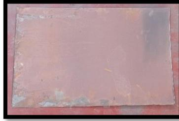
**Figura 19:** Plancha antes del proceso de arenado.
