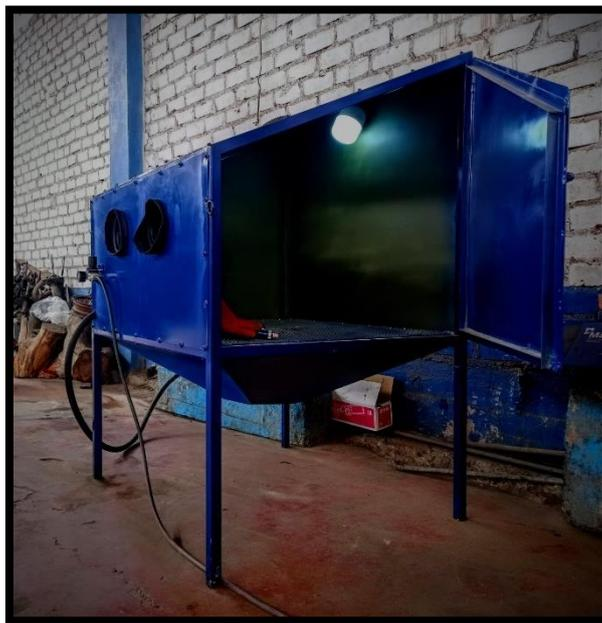
**Figura 30:** Cabina lista para proceso de arenado.
