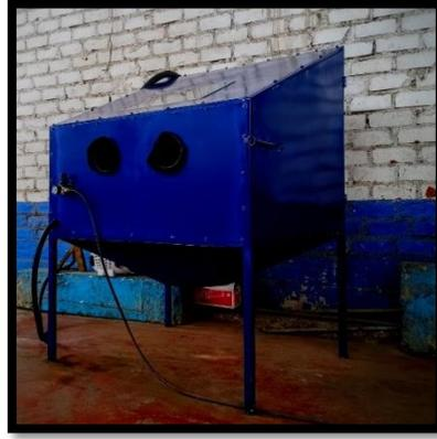
**Figura 10:** Cabina de arenado propuesto.
