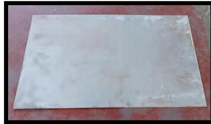
**Figura 20:** Plancha después del proceso de arenado.
