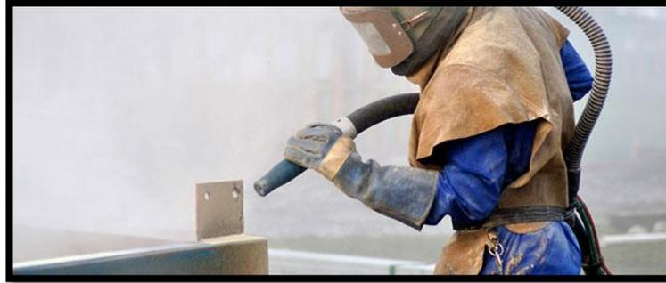
**Figura 1:** Aplicación de chorro abrasivo.
