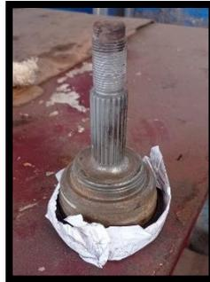
**Figura 11:** Junta antes del proceso de arenado.
