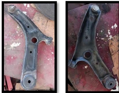
**Figura 14:** Trapecio después del proceso de arenado.
