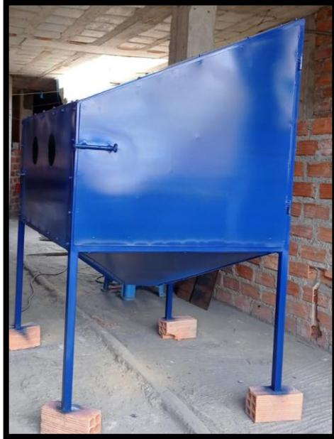
**Figura 29:** Acabado final de cabina de arenado.
