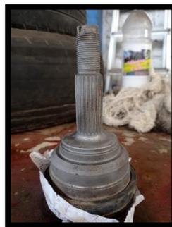
**Figura 12:** Junta después del proceso de arenado.
