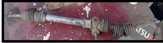
**Figura 16:** Cremallera después del proceso de arenado.
