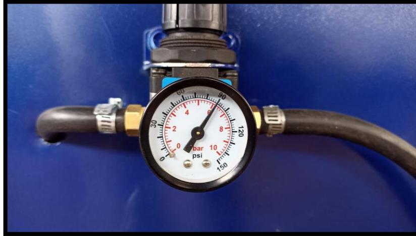
**Figura 31:** Válvula regulada a 90psi para trabajo.
