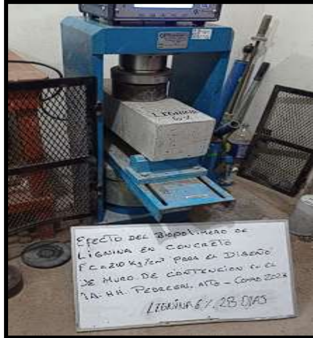
Figura N°90. Resistencia a flexión de concreto con 6% de lignina a los 28 días.
