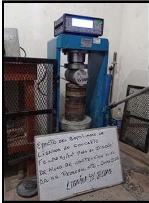
Figura N°61. Resistencia a tracción de concreto con 4% de lignina a 28 días.
