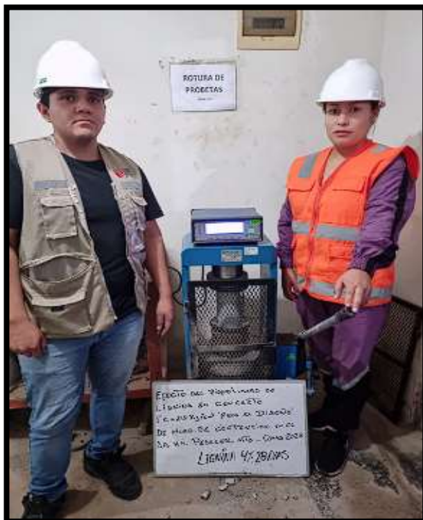
Figura N°37. Compresión de concreto con biopolímero de lignina al 4%, a 28 días.
