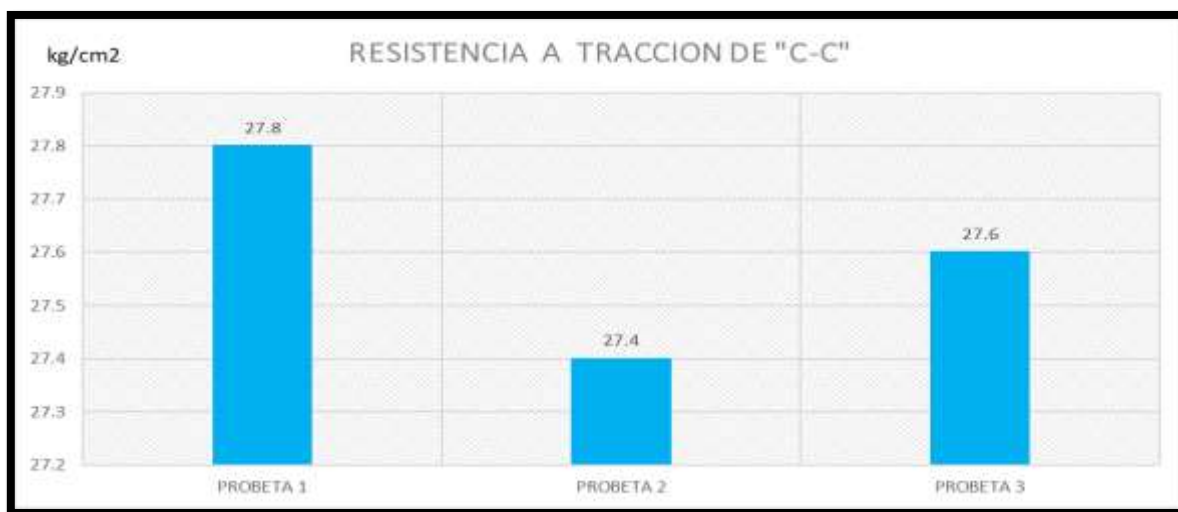
Figura N°44. Resistencia a tracción del concreto convencional, resultados a 7 días.
