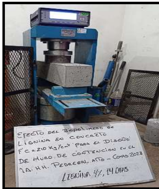
Figura N°80. Resistencia a flexión de concreto con 4% de lignina a los 14 días.
