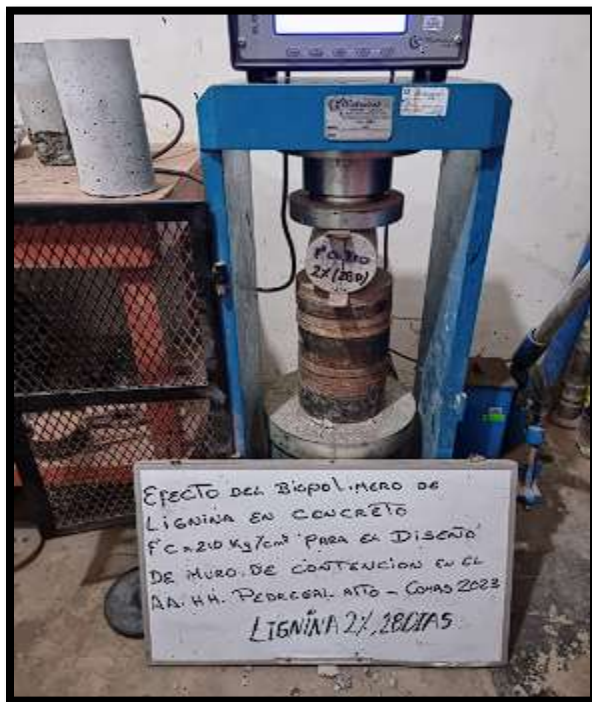
Figura N°59. Resistencia a tracción de concreto con 2% de lignina a 28 días.
