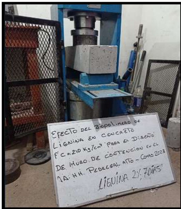
Figura N°70. Resistencia a flexión de concreto con 2% de lignina a 7 días.
