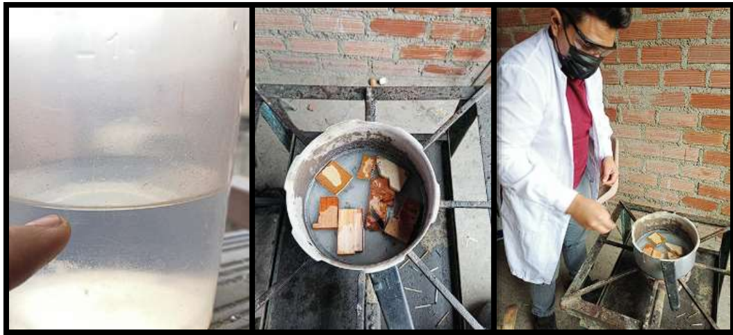
Figura N°11. Proceso de eliminación de impurezas de la madera.
