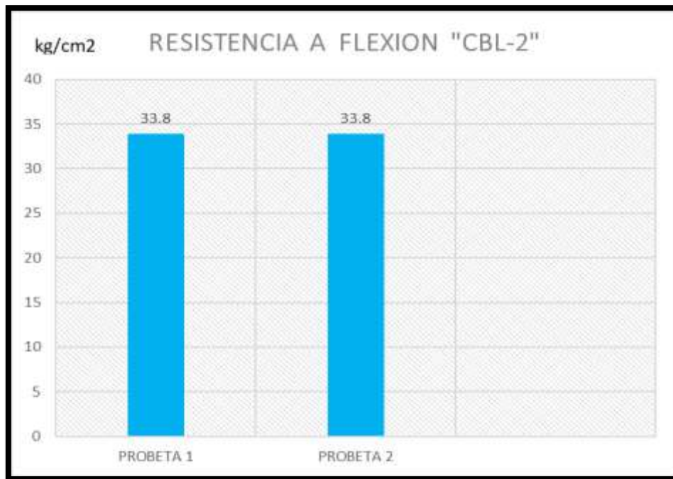
Figura N°73. Resistencia a flexión con 4% de lignina, resultados a 7 días.
