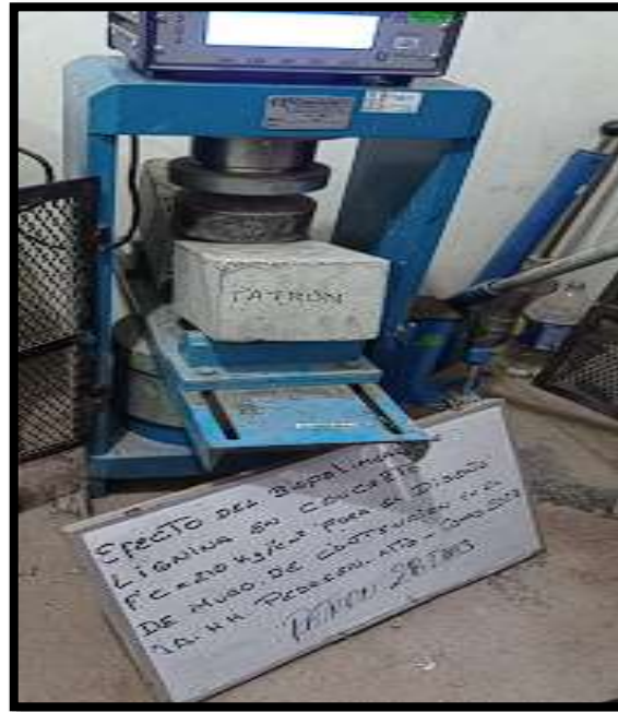
Figura N°84. Resistencia a flexión de concreto convencional a los 28 días.
