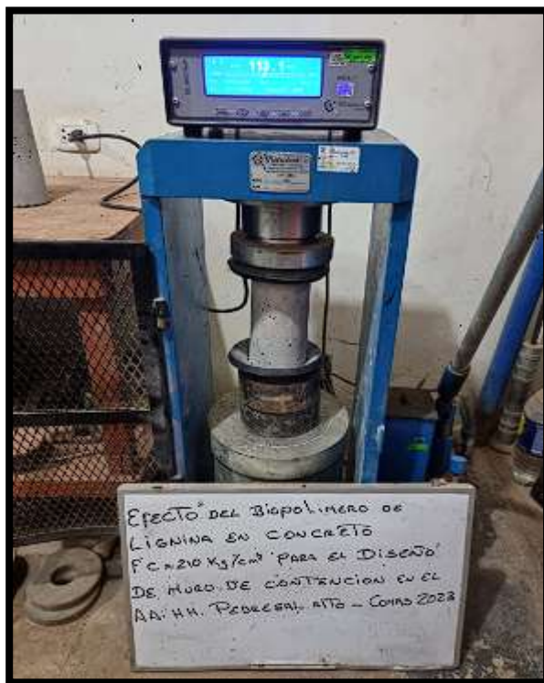
Figura N°25. Compresión de concreto convencional a 14 días.
