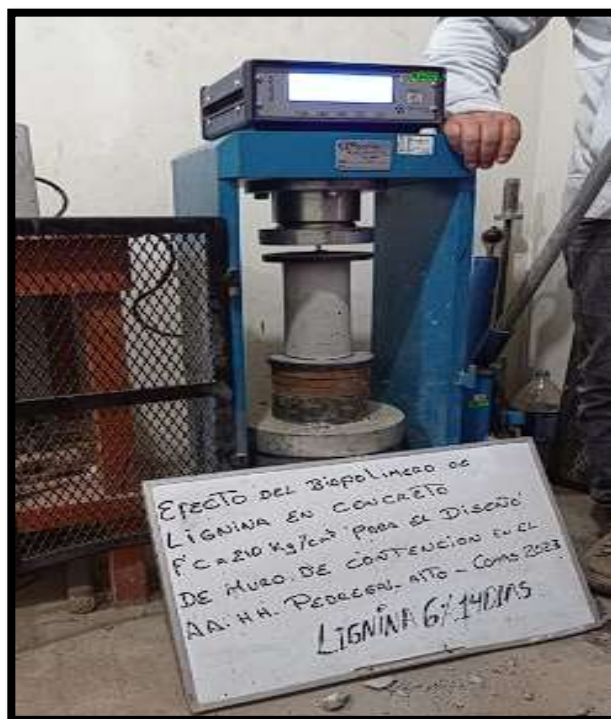
Figura N°31. Compresión de concreto con biopolímero de lignina al 6%, a 14 días.
