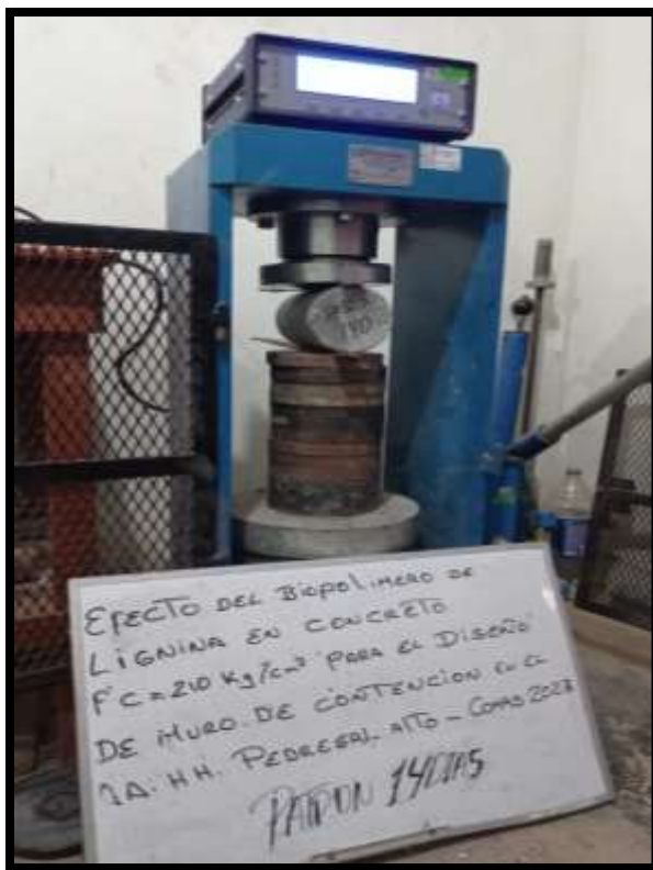
Figura N°50. Resistencia a tracción de concreto convencional a 14 días.
