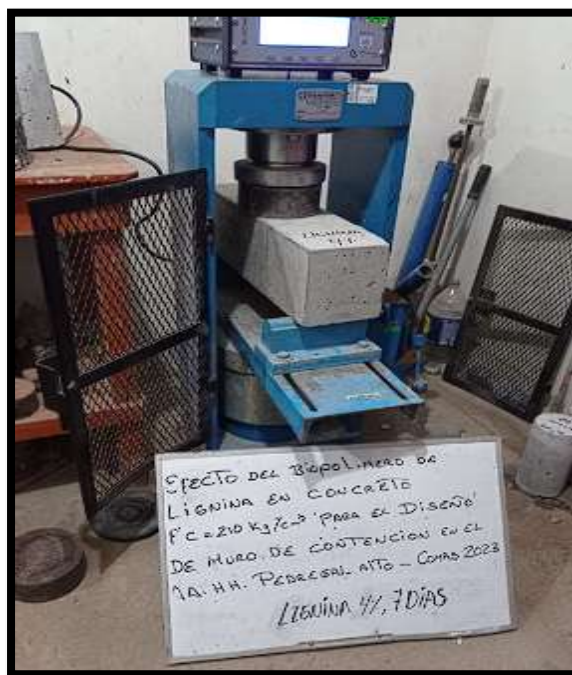
Figura N°72. Resistencia a flexión de concreto con 4% de lignina a 7 días.
