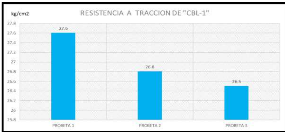
Figura N°45. Resistencia a tracción del concreto con 2% de lignina, resultados a 7 días.
