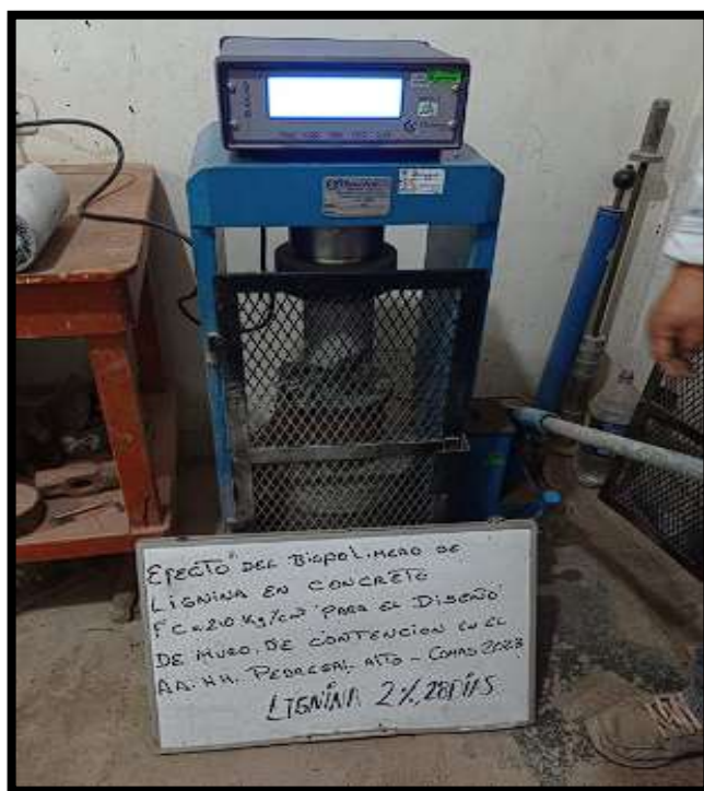
Figura N°35. Compresión de concreto con biopolímero de lignina al 2%, a 28 días.
