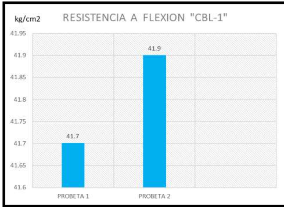
Figura N°87. Resistencia a flexión de concreto con 2% de lignina, a los 28 días.
