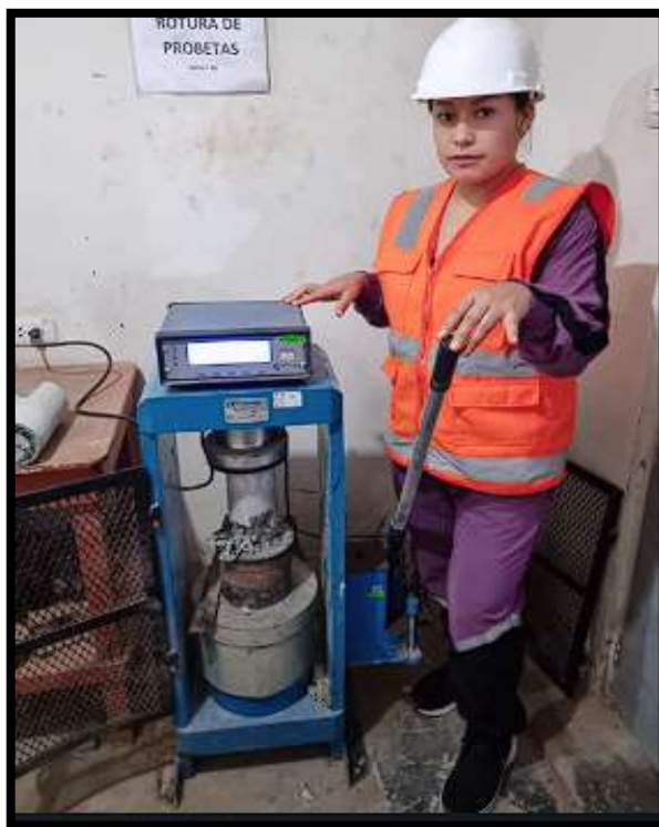
Figura N°39. Compresión de concreto con biopolímero de lignina al 6%, a 28 días.
