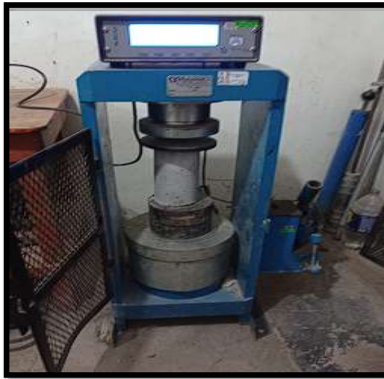
Figura N°17. Compresión de concreto convencional a 7 días.
