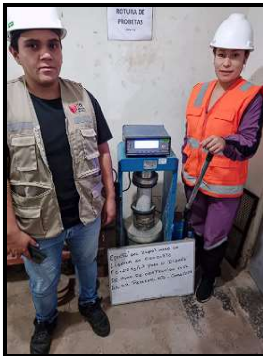
Figura N°33. Compresión de concreto convencional a 28 días.
