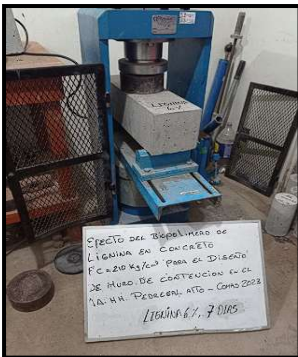
Figura N°74. Resistencia a flexión de concreto con 6% de lignina a 7 días.
