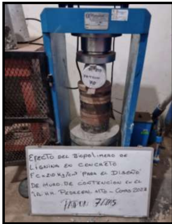
Figura N°43. Resistencia a tracción del concreto convencional a 7 días.
