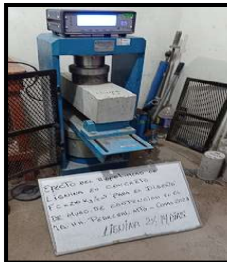
Figura N°78. Resistencia a flexión de concreto con 2% de lignina a los 14 días.
