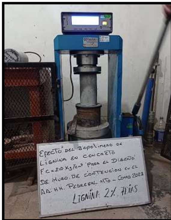
Figura N°19. Resistencia a Compresión con adición de lignina al 2%.
