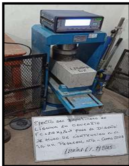
Figura N°82. Resistencia a flexión de concreto con 6% de lignina a los 14 días.
