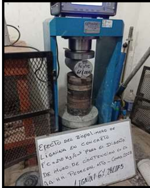
Figura N°63. Resistencia a tracción de concreto con 6% de lignina a 28 días.
