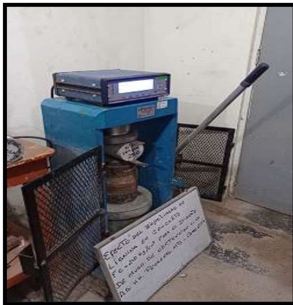
Figura N°48. Resistencia a tracción del concreto con 6% de lignina a 7 días.
