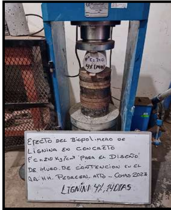
Figura N°53. Resistencia a tracción de concreto con 4% de lignina a 14 días.
