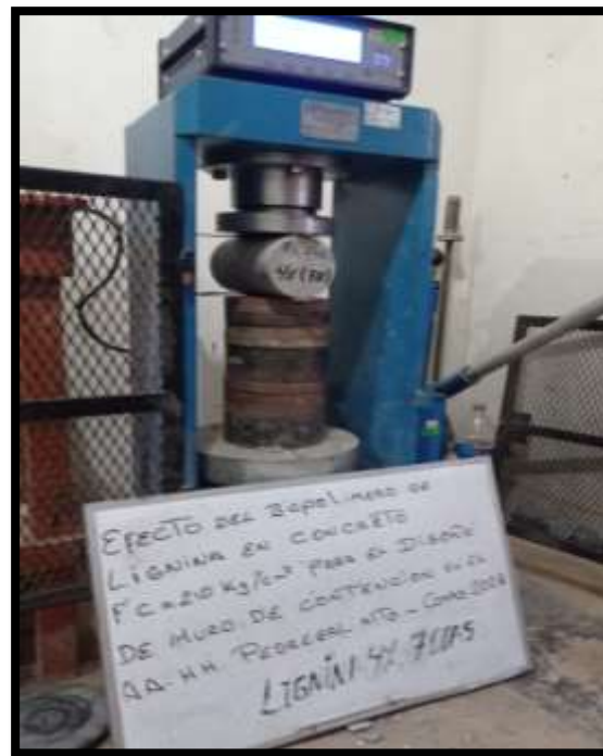
Figura N°46. Resistencia a tracción del concreto con 4% de lignina a 7 días.
