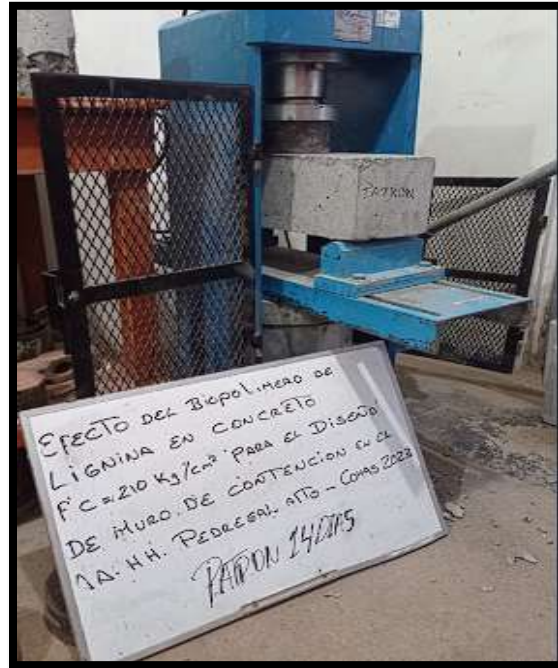
Figura N°76. Resistencia a flexión de concreto convencional a los 14 días.
