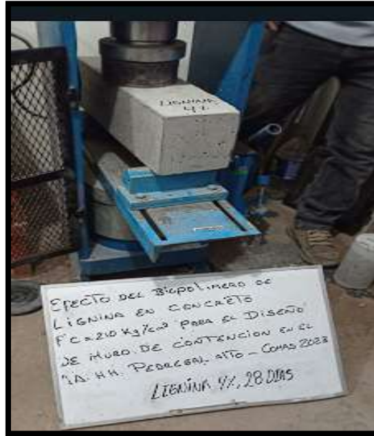
Figura N°88. Resistencia a flexión de concreto con 4% de lignina a los 28 días.
