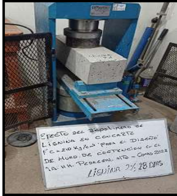
Figura N°86. Resistencia a flexión de concreto con 2% de lignina a los 28 días.
