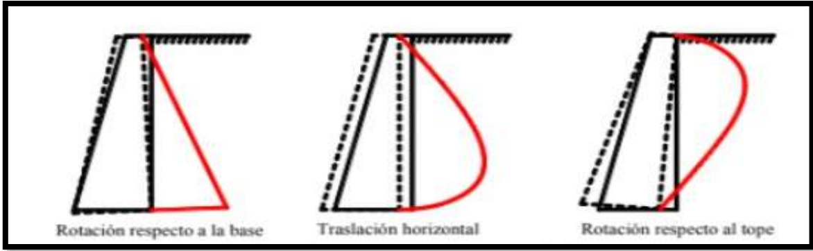
Figura N°2: empuje activo contra muro de contención
