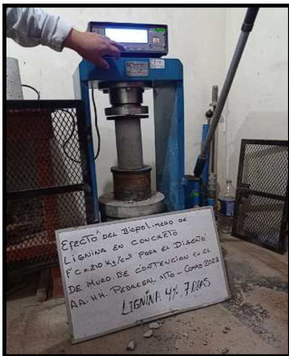
Figura N°21. Resistencia a Compresión con adición de lignina al 4%.
