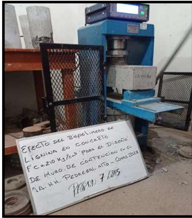
Figura N°68. Resistencia a flexión de concreto convencional a 7 días.
