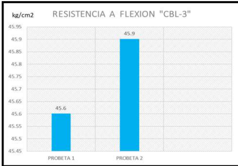
Figura N°91. Resistencia a flexión de concreto con 6% de lignina, a los 28 días.
