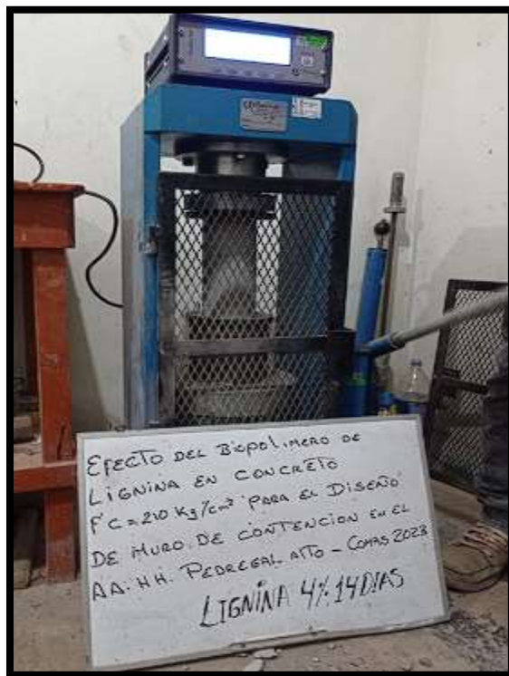
Figura N°29. Compresión de concreto con biopolímero de lignina al 4%, a 14 días.
