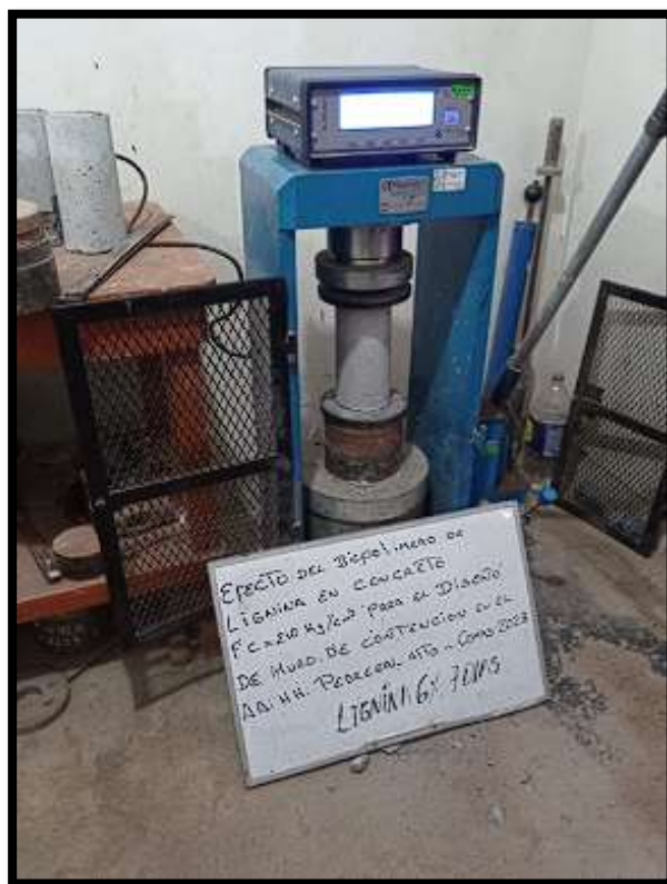
Figura N°23. Resistencia a Compresión con adición de lignina al 6%.
