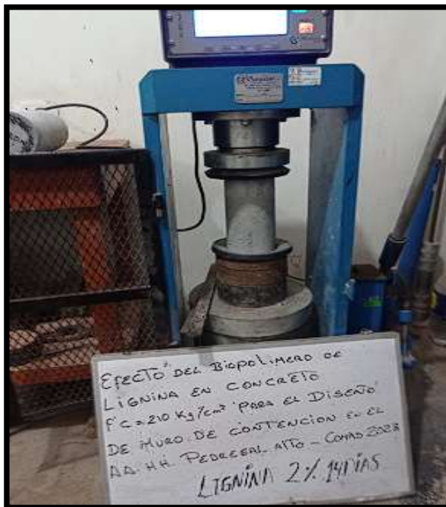
Figura N°27. Compresión de concreto con biopolímero de lignina al 2%, a 14 días.
