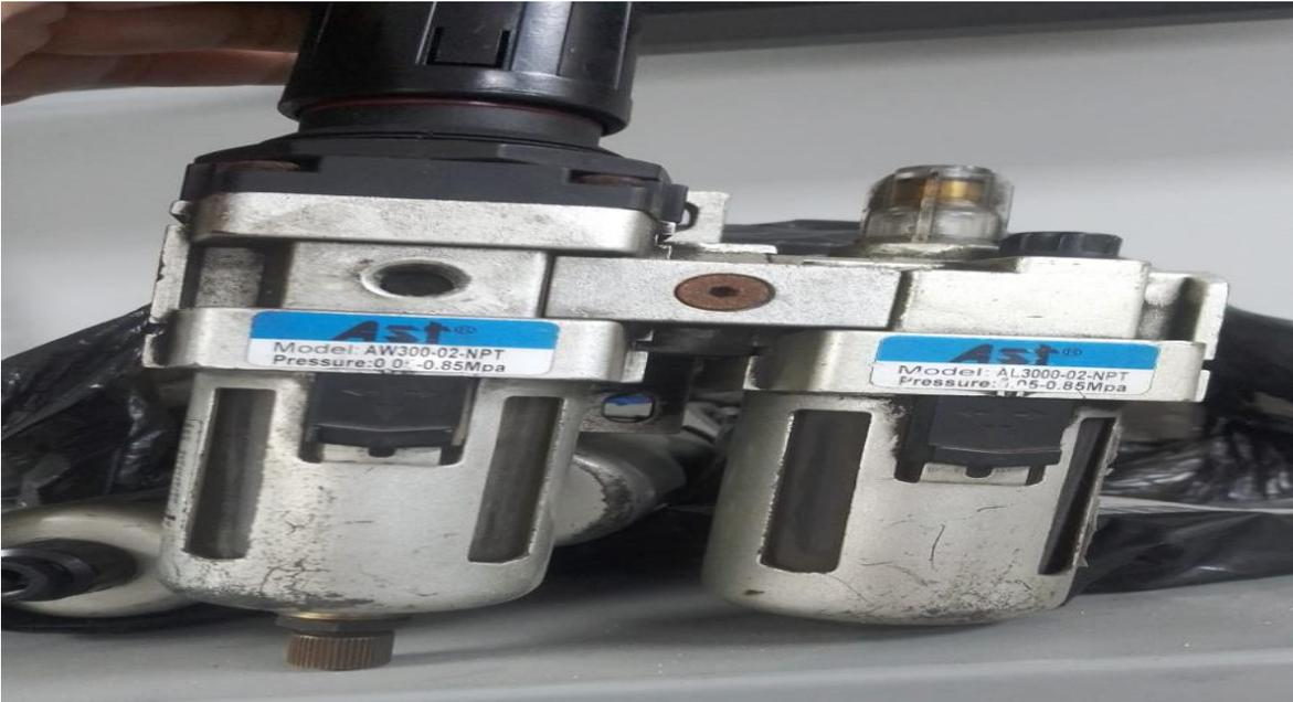
**Figura 14.** Verificación de la presión de enzunchadoras
