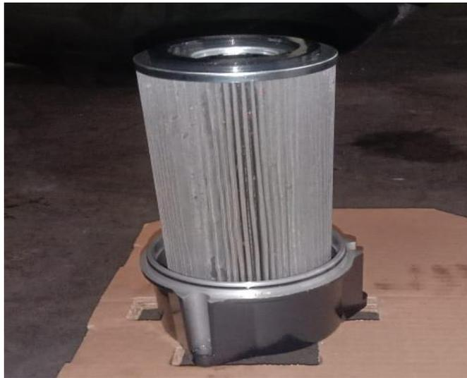
Gambar 10 Memosisikan komponen *filter* oli *hydraulic* berada diatas *cover filter* oli *hydraulic*
