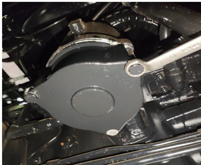
Gambar 6 Proses Melepas *Cover Filter Oli Hydraulic*
