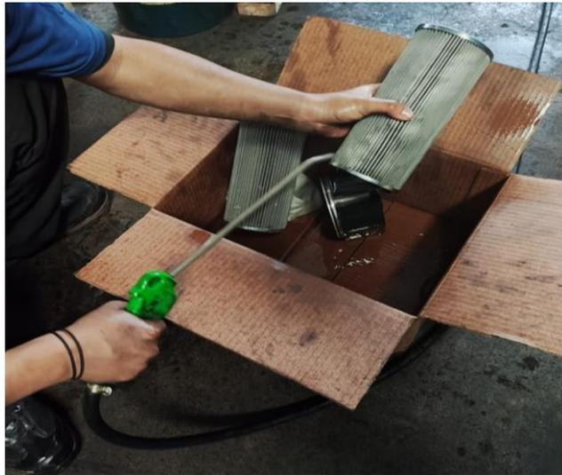
Gambar 9 Proses Pembersihan *Filter Oli Hydraulic*
