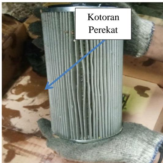
Gambar 8 Kotoran Pada *Filter* Oli *Hydraulic*
