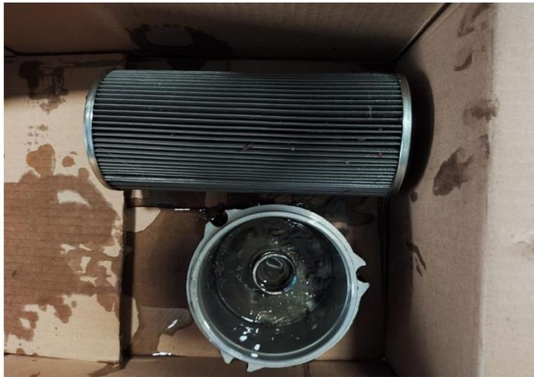
Gambar 7 Memindahkan Komponen *Filter* oli *Hydraulic* Ketempat Yang Bersih
