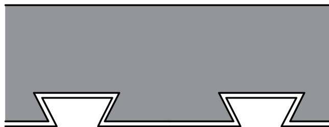
Kuva 3. Liittolevyn ja betonivalun muodostama liittolaatta (mukaillen SFS-EN 1994-1-1 2005, s. 80).
