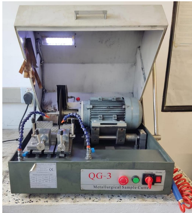
Figura 27. Pulidora de corte refrigerado modelo QG-3.
